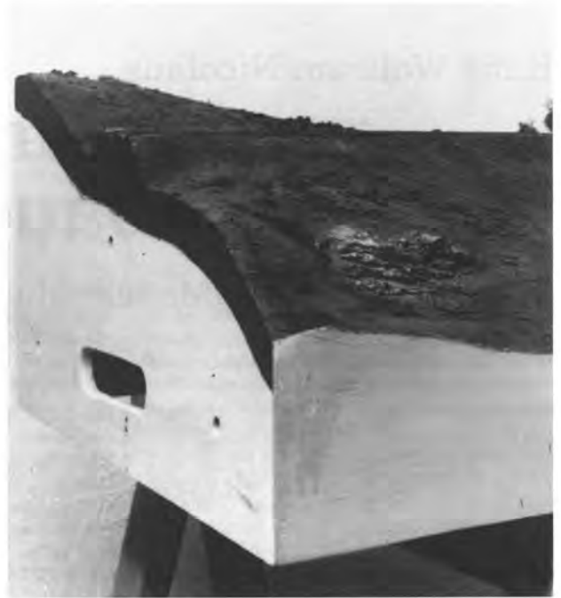
Abb. 3: Nochmals Endprofil und vorderes Längsprofil. Genaues Arbeiten ist erforderlich. Saubere Kanten machen sich gut: Hier ist zu spachteln und zu schleifen.
