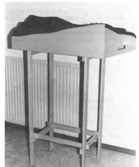
Abb. 5: Das fast fertige Modul steht auf eigenen Beinen. Es sind noch die Kabel mit den 4 mm-Bananensteckern zu beiden Seiten herauszuführen.
