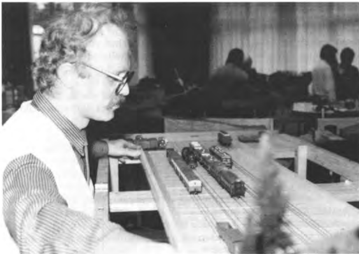
Bild 3: Der Fiddle Yard als »Verschiebebahnhof«: Die Querververschiebbarkeit erspart Weichen und Schaltungsaufwand. (Gruppe Minden).
