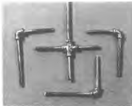
Abb. 4: Winkelstücke und Kreuzstück nach dem Löt- und Verfeilen.
