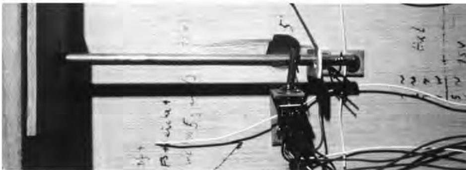
Abb. 4 (o.): Der »unterirdische« Teil des Antriebs mit Stellstange, Führungswinkel, Umschalter mit Führungshülse für den Stelldraht. Rechts außen der U-förmige Mitnehmer, Weichenlaterne und Stellhebel.
