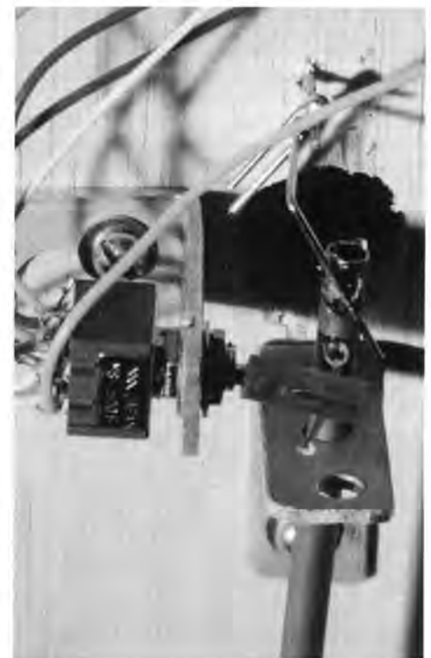
Abb. 4 (o.): Der »unterirdische« Teil des Antriebs mit Stellstange, Führungswinkel, Umschalter mit Führungshülse für den Stelldraht. Rechts außen der U-förmige Mitnehmer, Weichenlaterne und Stellhebel.
