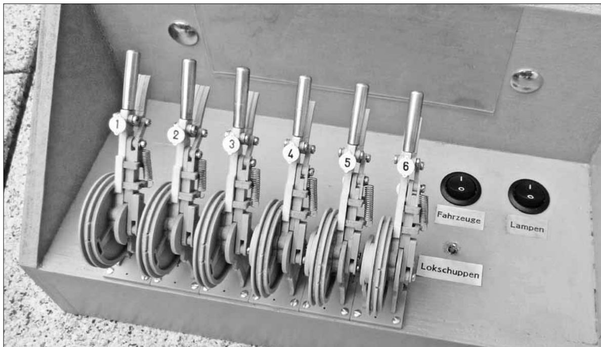
Die reparierte Hebelbank, fertig zum nächsten Einsatz
