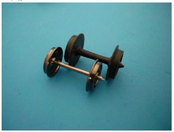
Achsdurchmesser von mehr als 2mm (manche Klein- Fahrzeuge, im Bild hinten) sind allerdings ein absolutes KO- Kriterium, da diese nicht mehr in die Gabeln der Rollböcke passen. Einige Radsätze
